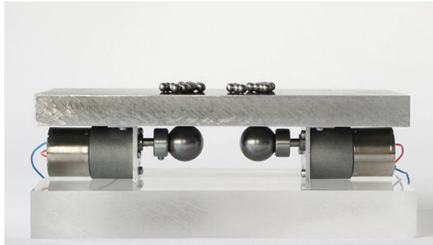
2 Kugelmagnete des Typs K-26-C ( www.supermagnete.ch/K-26-C ) und 28 Stahlkugeln mit 3 mm Durchmesser
