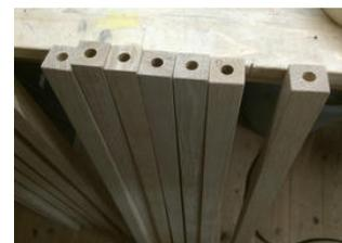
In die Bohrungen werden rechtsgängige Gewindehülsen eingeschraubt. In der Schweiz sind die Gewindehülsen erhältlich im Jumbo oder im Hasler Proficenter.
