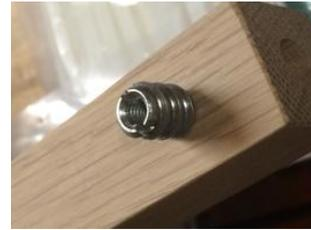
Danach können die Topfmagnete in die Gewindehülsen eingeschraubt werden.
